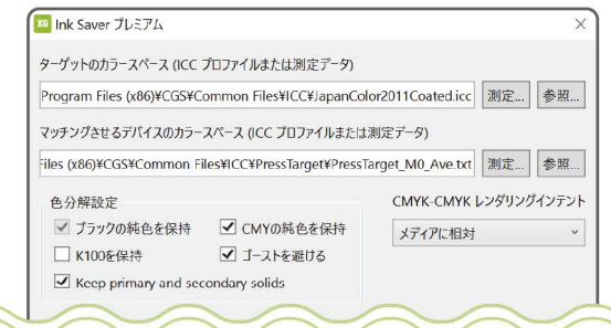
カラーマッチングとインキ削減を同時に行う《Ink Saver プレミアム》 (カラーマッチング部 抜粋)
